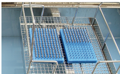
Очистка азотной кислотой
